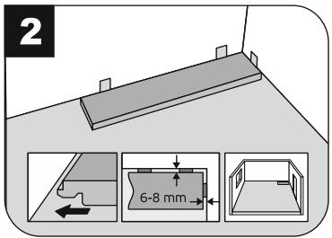
Необходимо соблюдать монтажные деформационные зазоры: не менее 6-8 мм от края покрытия до стен. Укладка кварцевого ламината начинается с формирования первого «маякового» ряда. От ровности его монтажа зависит ровность и качество всей укладки. Внимание: при укладке на тёплый пол деформационные зазоры должны быть не менее 10мм.
