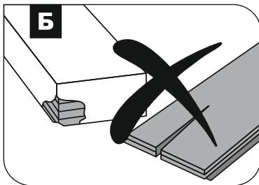
Пожалуйста, проверяйте купленные пачки: они должны быть целыми и не иметь повреждений. Поврежденные плашки нельзя использовать при укладке.
