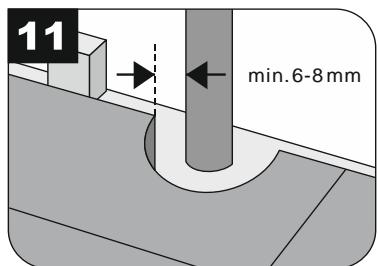
Необходимо соблюдать монтажные деформационные зазоры не менее 6-8 мм от края покрытия до выдающихся над поверхностью пола элементов (трубы, лестницы, колонны, перегородки, пороги и т. п.).
