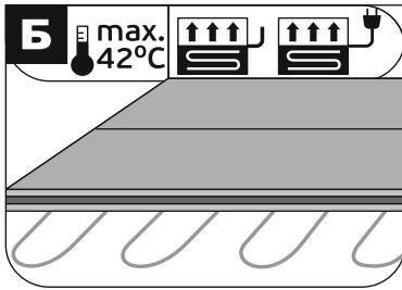
При использовании системы напольного водяного или электрического отопления учитывайте, что максимальная температура нагрева не должна превышать +42°C.
