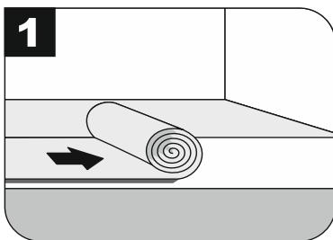
Для компенсации неровностей основания и обеспечения комфорта при эксплуатации расстилается подложка 1 - 1,5 мм. Подложка укладывается встык при помощи клейкой ленты. Перед укладкой напольного покрытия измерьте ширину помещения, чтобы рассчитать, сколько рядов кварцевого ламината потребуется. Если ширина последнего ряда — меньше 50 мм, необходимо обрезать плашки первого ряда, чтобы сместить все напольное покрытие в центр.
