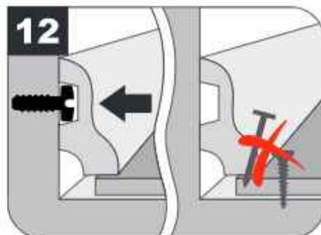
**7.4.10** Иногда при монтаже пола возникает ситуация невозможности установки плашки из-за помехи.
