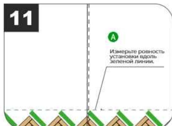
Отрежьте левый край так, чтобы он соответствовал размеру помещения с учетом зазора для расширения 8 мм.
