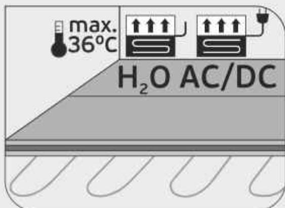
3.6 При укладке SPC-покрытия высокой плотности (кварцевого ламината FARGO) на подогреваемые полы систему нужно отключить за 3-4 суток до начала укладки и включить после завершения всех работ по монтажу напольного покрытия.
