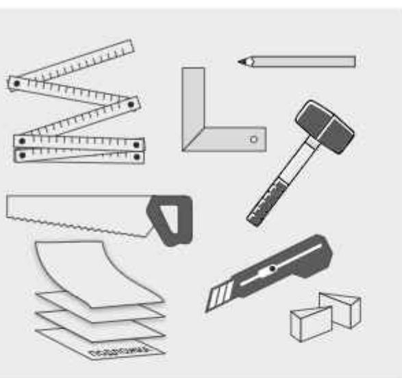
**6.1** Для укладки SPC-покрытия высокой плотности (кварцевого ламината FARGO) потребуются линейка, карандаш, пила (или электролобзик), угольник, распорные клинья, нож, резиновая киянка, плотная подложка толщиной 1,5 мм.
